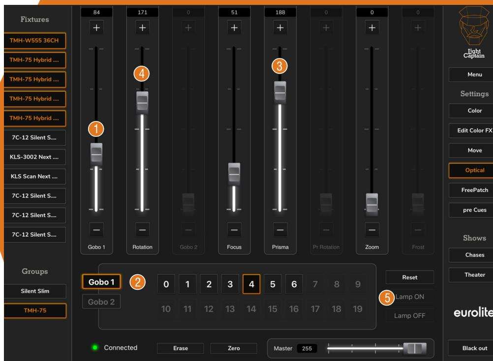
Auf dieser Seite befinden sich die verschiedenen optischen Funktionen von Scheinwerfern. Gobos und ihre Rotation können über die Fader **1**, die Gobos aber auch über die Direktwahltasten **2** unten abgerufen werden. Bei Prisma **3** hängt es vom Scheinwerfer ab, ob die Rotation schon mit auf diesem Fader liegt oder auf dem Rotation-Fader **4**. Reset, Lamp On und Lamp Off **5** müssen bei den meisten Scheinwerfern etwa 3 Sekunden den Befehl bekommen bis sie ihn auslösen.
